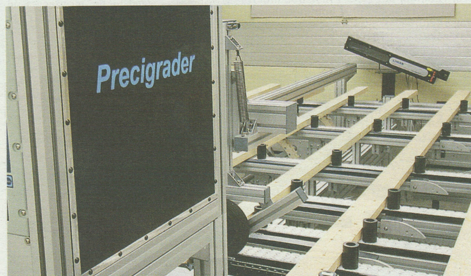
Maschinelle Festigkeitssortierung System „Precigrader“ (Dynalyse)
