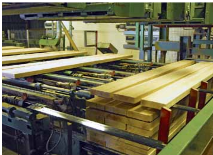
Fertigpaket in 40 Sekunden war der Rekord in Vilshofen – hier werden 1,2 m-Pakete von der Springer-Paketierung aufgesetzt
