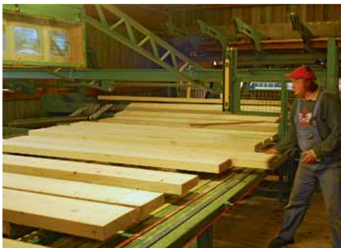
Zu schnell für die Kamera: Kette mit Ziehrollen erlaubt einfache Bewegung der schweren KVH-Rohware
