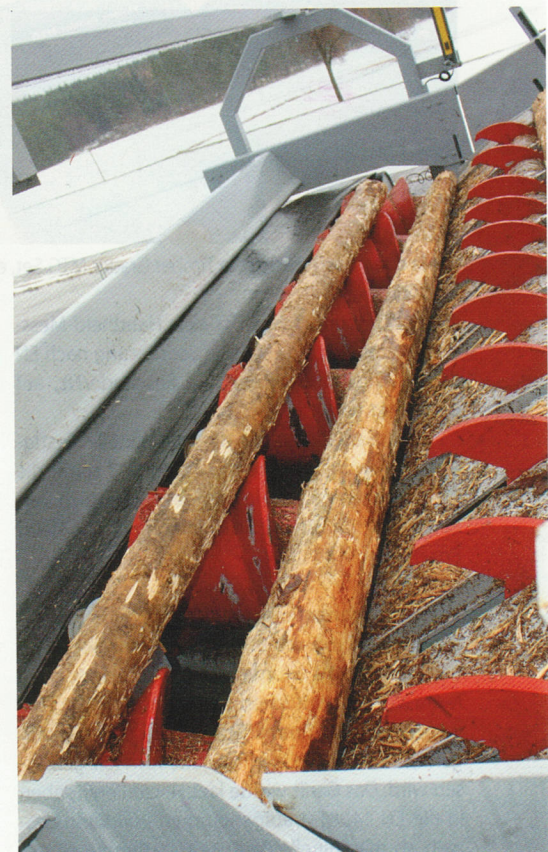
Screw Feeder: durch die gleichzeitige Dreh- und Vorwärtsbewegung wird höhere Leistung erreicht
