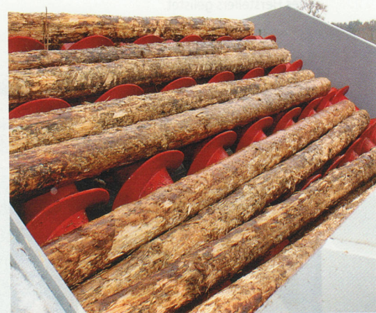
Mit Schraubrollen ausgeführte Vereinzelungsstufe in Richtung Wurzelreduzierer
