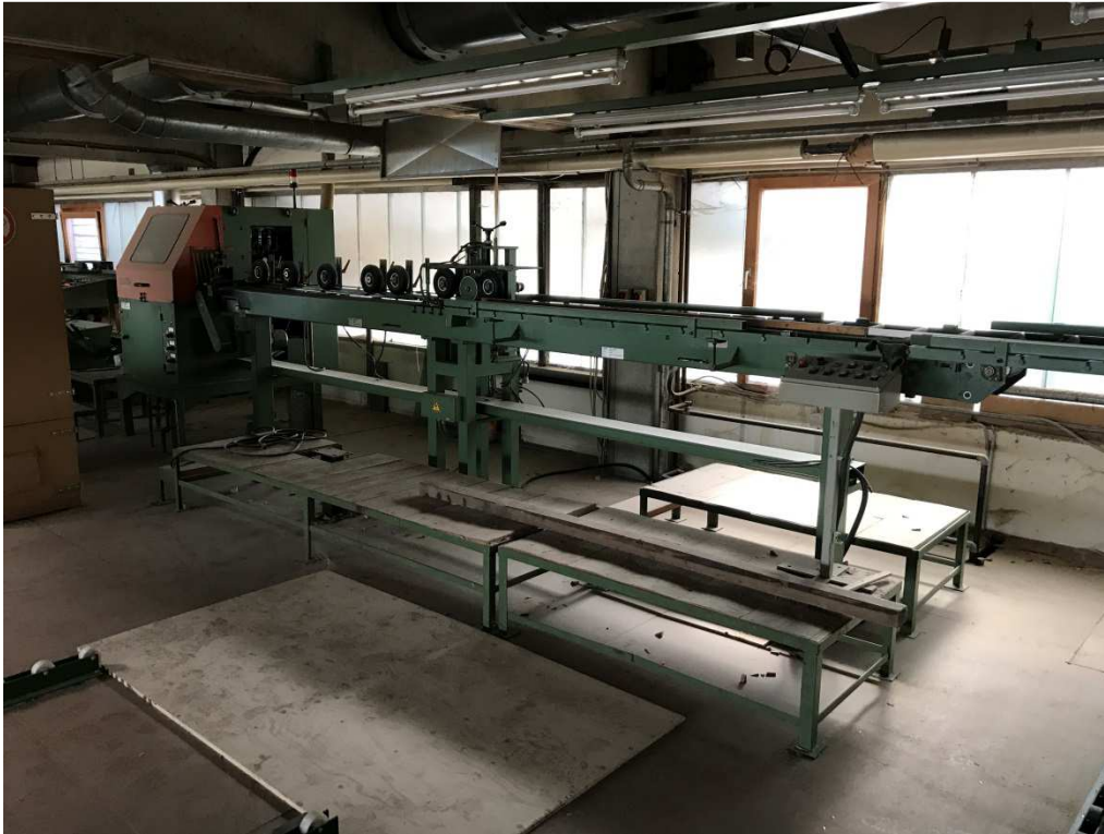
Zuführung zu Kappsäge mit Anzeichenplatz / mark station in front of cross cutsaw
