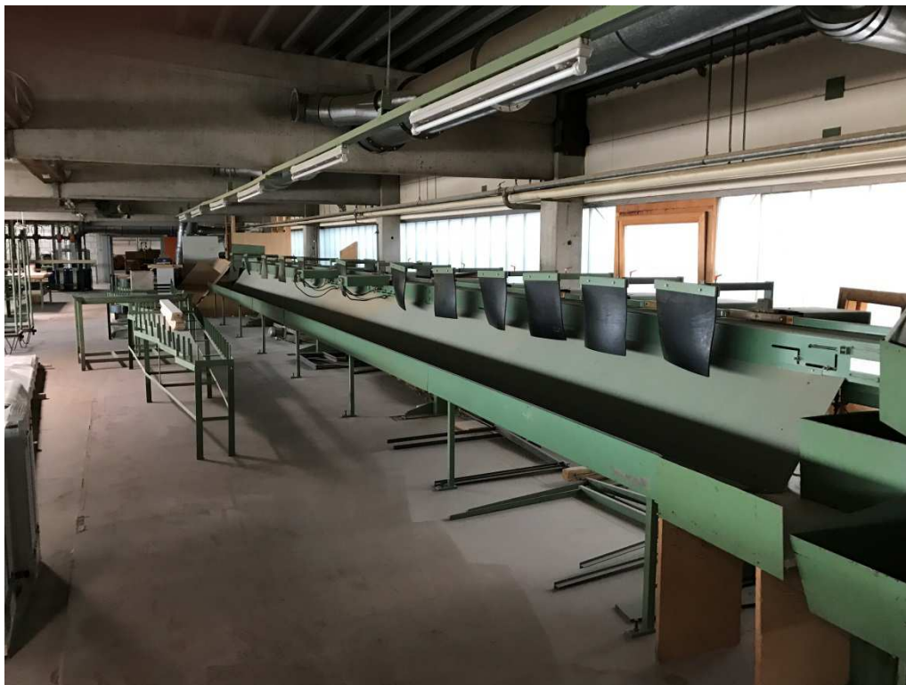
Sortierförderer mit 14 Abwurfstellen / sorting conveyor with 14 pneumatic flippers
